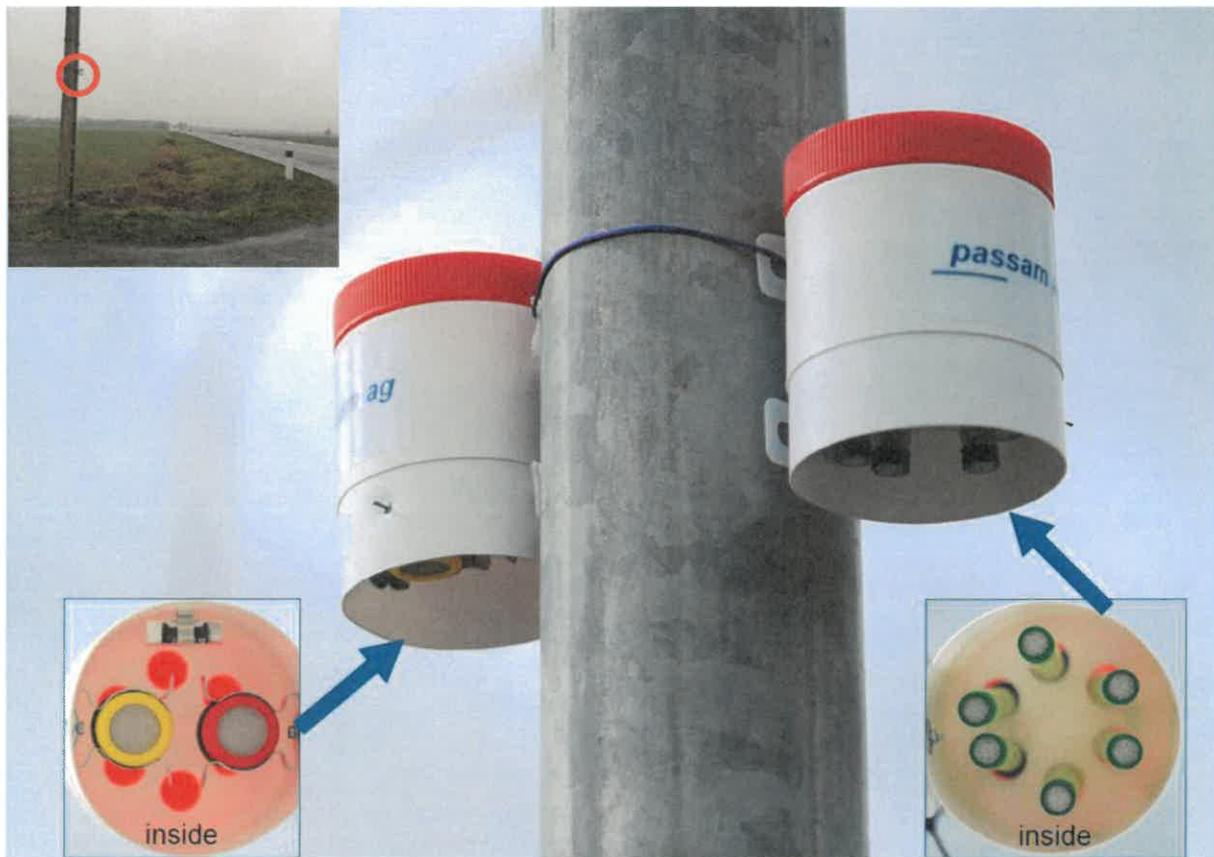
Figure 2. Exemple de dispositifs de mesures passifs – non contractuel (EVADIES et PASSAM AG)
